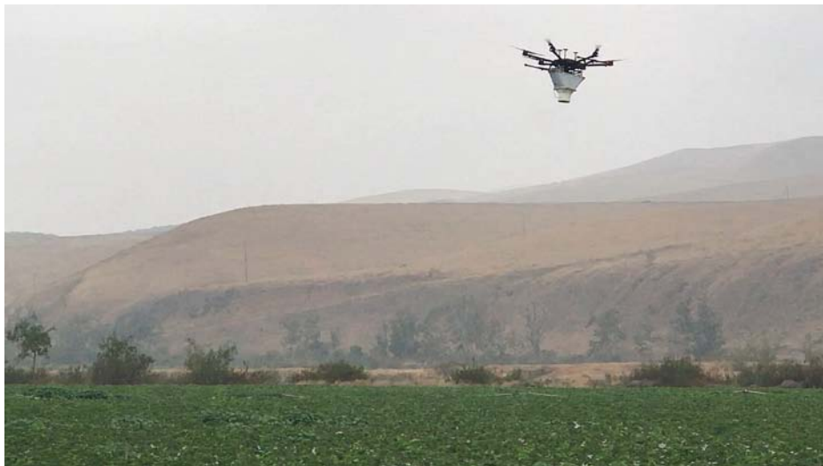
图19-11 无人机在草莓田投放益虫 (图片来源: UAV-IQ)
