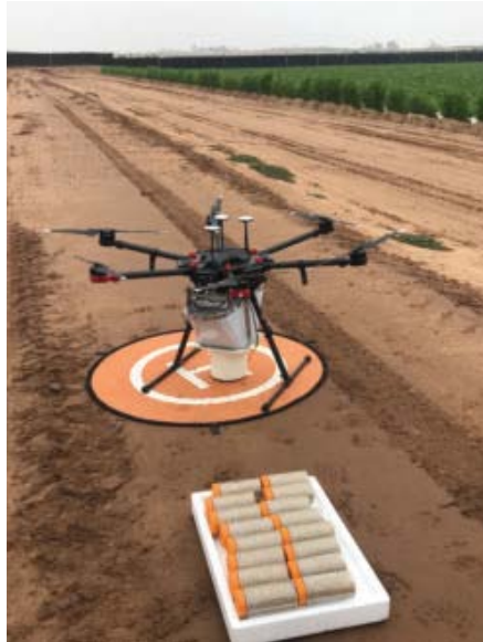
图19-12 一台具有益虫装载器无人机等待起飞
