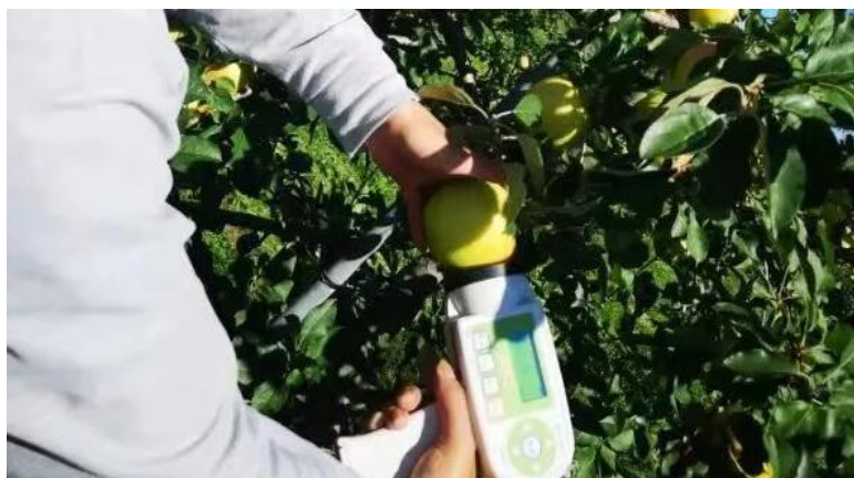
图 18-3 三浦的仪器可以直接测出糖度
