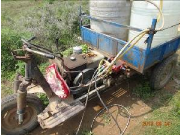
图 12-11 以柴油机作动力的三联泵喷雾设备
